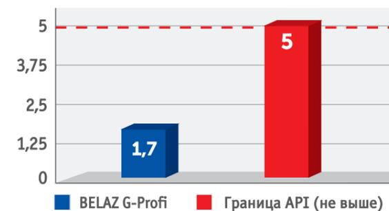
Износ кулачка толкателя (усредненный по 8 впускным клапанам),  $\mu\text{m}$
