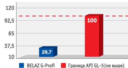
Противоизносные свойства ASTM D6121, балл
